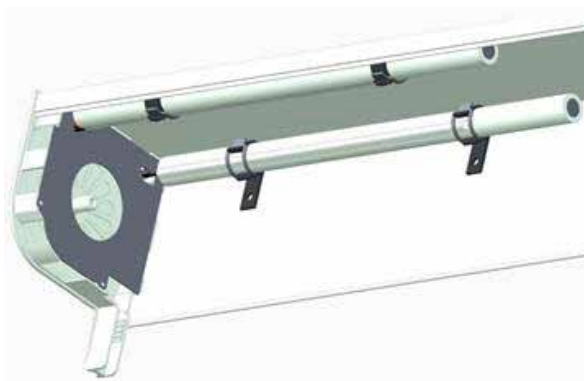
Příklad umístění baterie uvnitř boxu. Baterie umístěná uvnitř boxu platí pouze pro velikost 150. U ostatních boxů je umístěna mimo box.
